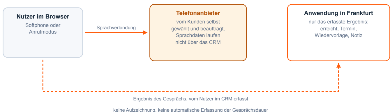
Abbildung 5: Trennung von Sprachverbindung und CRM-Daten.
